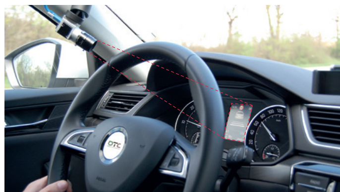
Kamera und Mikrofon werden nahe am Kombiinstrument mittels Saugnapf montiert. Keine Beeinträchtigung während der Fahrt.
